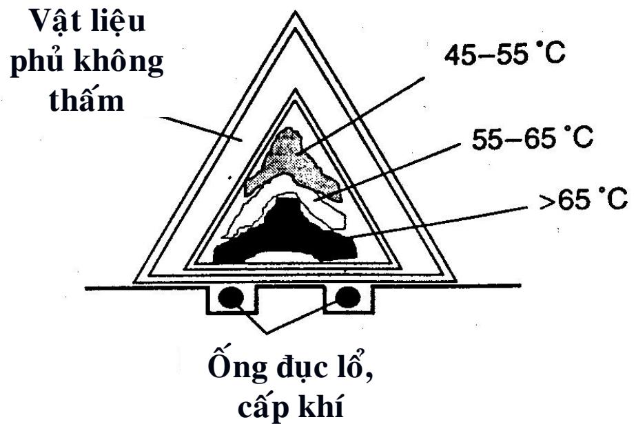
Sự phân bố nhiệt độ trong hệ thống làm phân. Hoạt động của vi sinh vật phân hủy chất hữu cơ đã tạo nên các vùng nhiệt độ khác nhau. Việc cấp khí giúp cho các vi sinh vật phân hủy chất hữu cơ phát triển
